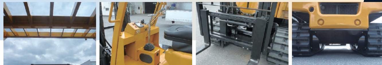
ポリカーボネート板 キャノピ天井の上方視界を確保。
