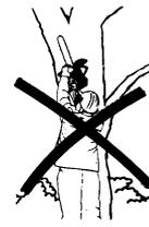
8. ガイドバーの先端部での切断はしないでください。また、ガイドバーの先端部を枝や地面などに触れさせないように作業してください。
