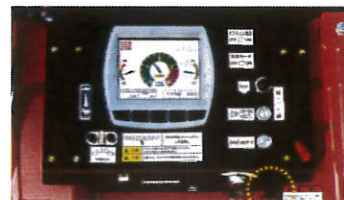
緊急時の停止! 作業者は非常停止スイッチと連結したヒモを体に結ぶことで、万一転落などによって作業者が車両から離れた場合でも、ヒモが引かれて非常停止スイッチが作動、エンジンが停止します。
