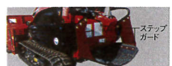
オペレータの転落防止! 左右のステップガードが横方向の転落からオペレータを守ります!
