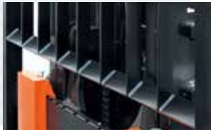
フォーク先端視野 バックレストのロアステーの斜め配置などにより、すっきり見やすいフォーク先端視野を確保しました。
