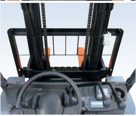
フォーク先端視野 バックレストのロアステーの斜め配置などにより、すっきり見やすいフォーク先端視野を確保しました。
