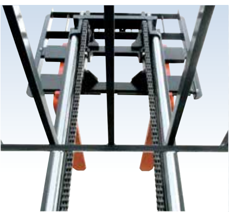
上方視野 先端部を斜め配置した格子型ヘッドガードの採用により、広い上方視野を確保しました。
