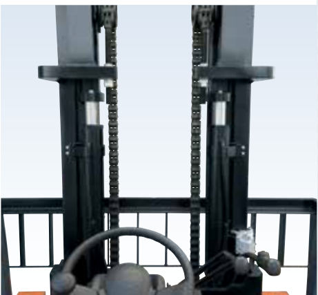
前方視野 マスト内配管の最適化などにより、広々とした前方視野を確保しました。
