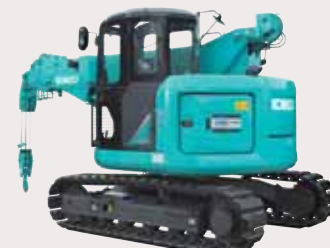
●旋回フラッシュ ●過負荷外部表示灯 ●後方確認カメラカラーモニター(オプション) ●走行/旋回アラーム(オプション) ●後方作業灯(オプション)
