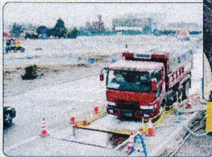
本機は、21~10tの標準ダンプトラック専用の タイヤ洗浄機です。
