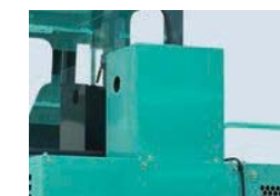
エンジン冷却水タンク
