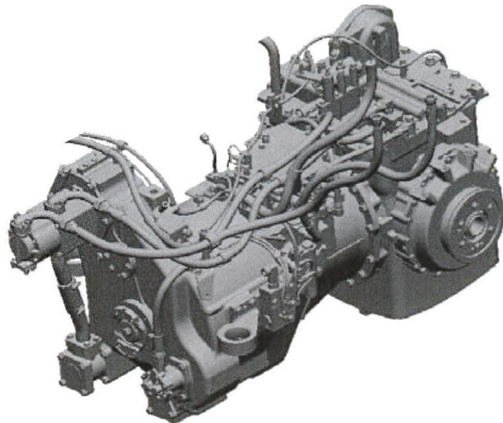
走行からドージング作業までの作業頻度の高い実用域では、ロックアップ機構が自動的に作動してエンジンパワーをダイレクトにトランクミッションに伝達。トルクコンバータを介さないことでパワーロスがありません。電子制御されたエンジンは余分なパワーを出力する必要がないので、けん引力を維持しながら大幅な燃費低減を図ることができます。
