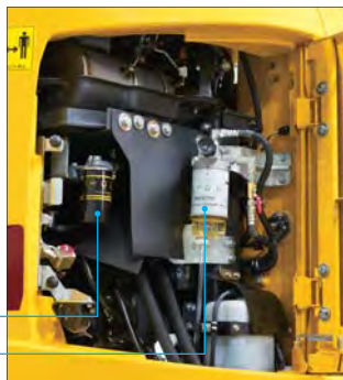
高効率燃料フィルタ ウォーターセパレータ機能付 燃料プレフィルタ
