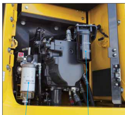
ウォーターセパレータ機能付 燃料プレフィルタ
