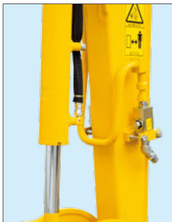
アタッチメント配管/ストップバルブ
