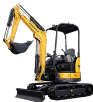
4柱キャノピー仕様(ROPS※1/FOPS※2基準)
